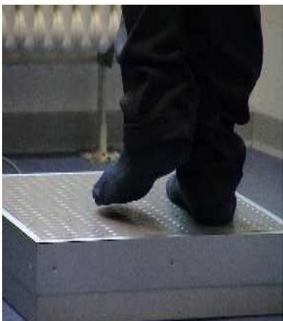
Durchführung: Die Probanden müssen 6 Sekunden einbeinig auf der Platte stehen. Je Seite werden 3 Wiederholungen durchgeführt.
