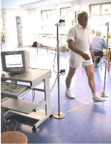
Die Gehgeschwindigkeit wird über eine Strecke von 6 Metern mit Hilfe von Lichtschranken berechnet.
